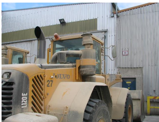
Pravilna postavitev filtra – TAKO NAJ BO POSTAVLJEN
